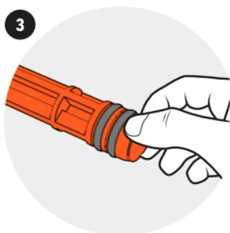
Remplacer le joint usé par un joint neuf stocké dans la poignée du piston.
