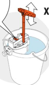
OFF – PUMP : pomper 2 ou 3 fois maximum pour mettre de l'eau purifiée sous pression.
