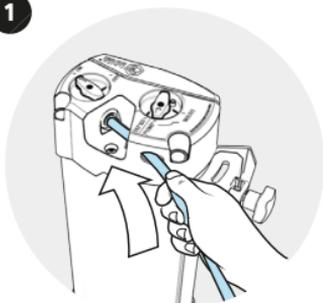
Insérer le tuyau <sup>Tuyau</sup> à l'extrémité du robinet. Pour l'enlever mettre les doigts de chaque côté de l'anneau gris, appuyer et tirer.
