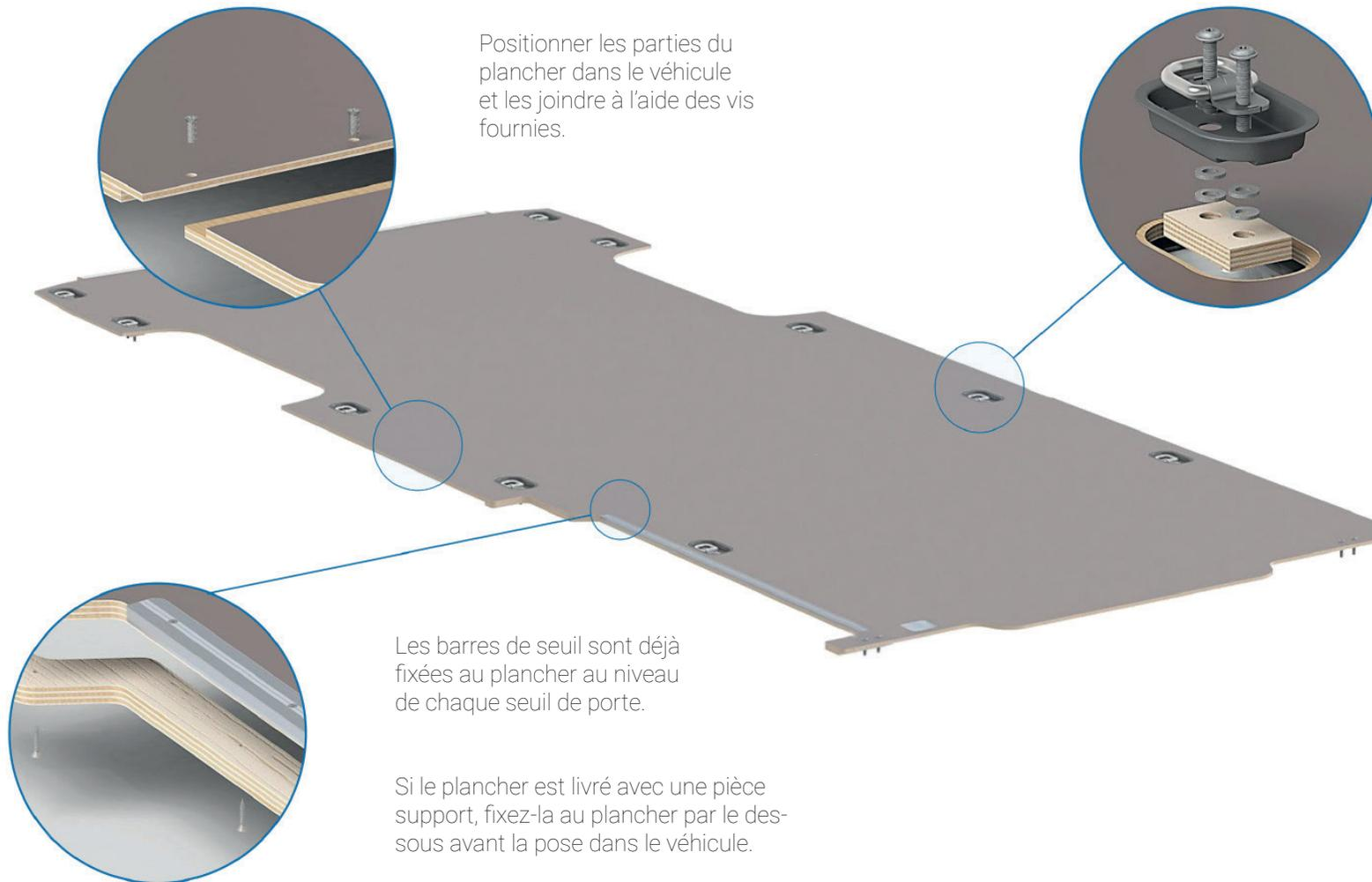
Positionner les parties du plancher dans le véhicule et les joindre à l'aide des vis fournies.
