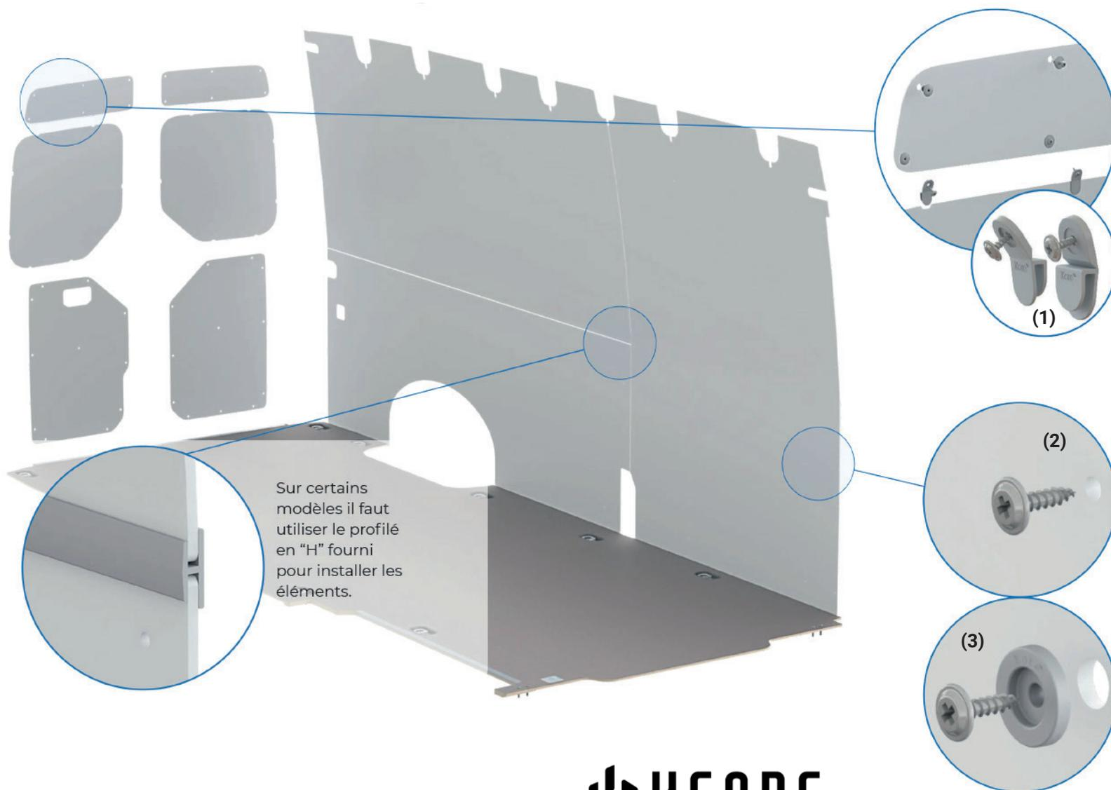
**(1)** Les médaillons à installer sur la **partie haute des portes** se fixent à l'aide des équerres de fixation en plastique. Placer les équerres dans le sens indiqué afin de fixer l'élément grâce aux vis autoperceuses fournies.
