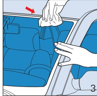
Nettoyer le cordon de colle restant sur la baie de pare-brise à l'aide du nettoyant universel Berner en bidon de 1000 ml. Il faut veiller que cette surface soit lisse, propre, exempte de graisse et ne pas la toucher avec les doigts.
