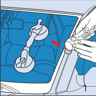
Retirer avec précaution la moulure et les pièces de revêtement selon les préconisations du constructeur automobile. Mettre en place les ventouses. Déposer le pare-brise à l'aide d'un décolleur pneumatique ou d'une corde à piano Berner.
